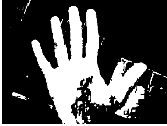
Figura 3.6. Resultado obtenido en la imagen en entorno hostil con método de segmentación basado en el color de la piel adaptado al escenario.
